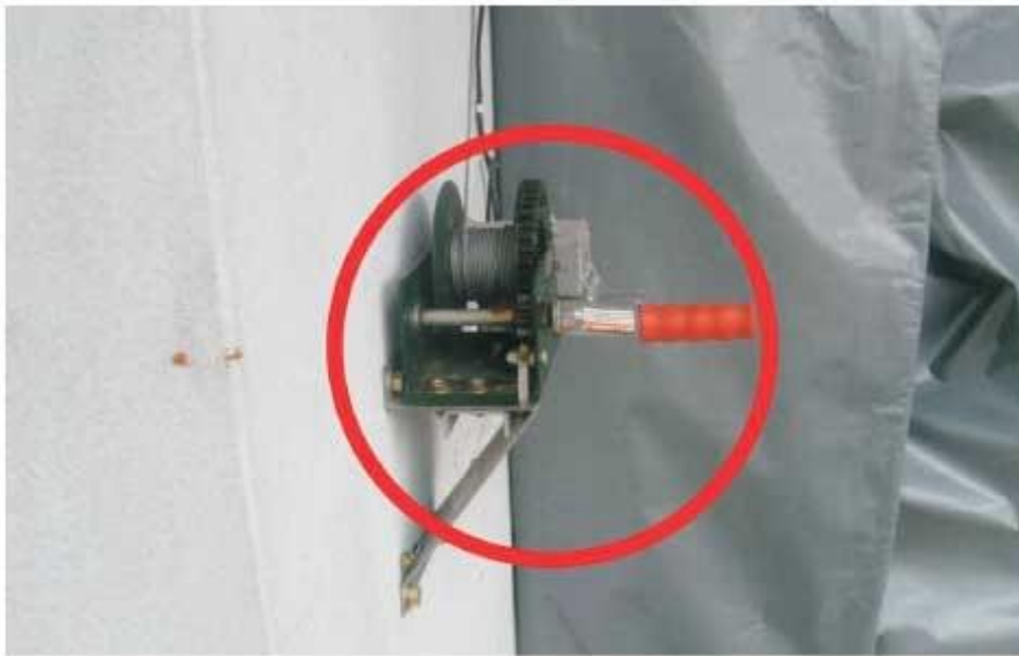
Fig. 4. Catraca para movimentação da cortina lateral. Foto: Jacir J. Albino Foto: Jacir J. Albino
